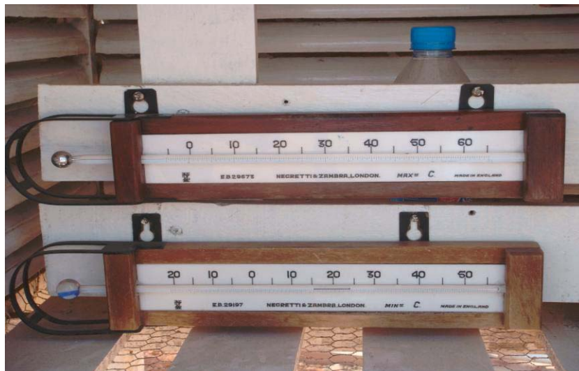
รูปที่ 3.4 เครื่องเทอร์โมมิเตอร์แบบสูงสุดและต่ำสุดสำหรับตรวจวัดอุณหภูมิสูงสุดและต่ำสุดประจำวัน
