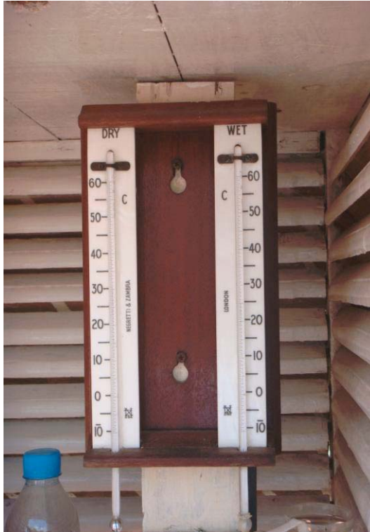
รูปที่ 3.5 เครื่องเทอร์โมมิเตอร์แบบตู้มั่งและเปียกสำหรับตรวจวัดอุณหภูมิเฉลี่ยและความชื้นสัมพัทธ์ประจำวัน
