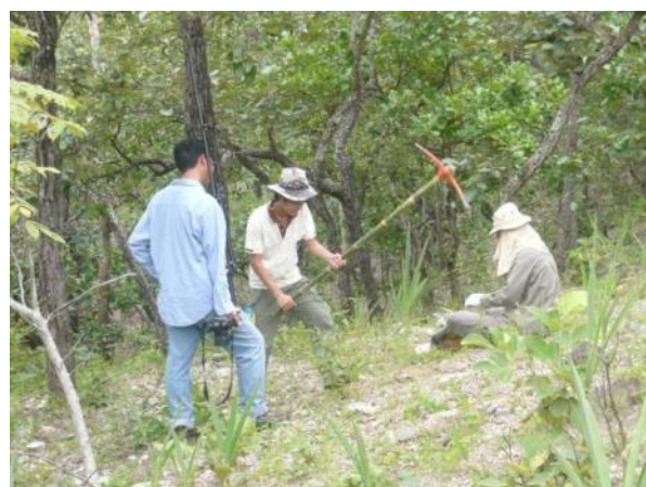
ภาพผนวกที่ 3. ภาพเก็บตัวอย่างดินที่ความลึก 15 และ 30 เซนติเมตร
