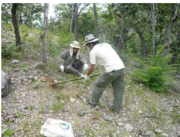
ภาพผนวกที่ 3. ภาพเก็บตัวอย่างดินที่ความลึก 15 และ 30 เซนติเมตร
