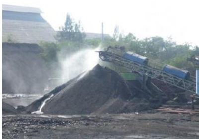
รูปที่ 4-6 การคัดแยกและการขนถ่าย ณ พื้นที่จุดเทกอง ของบริษัท ลานนา รีซอร์สเซส จำกัด (มหาชน)
