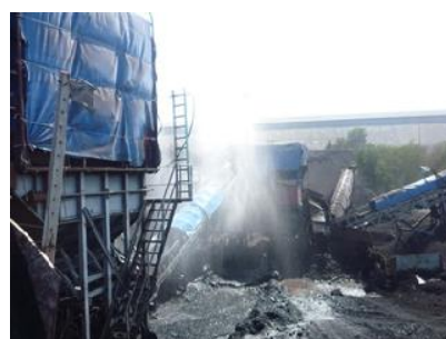
รูปที่ 4-7 การป้องกันการฟุ้งกระจาย ณ พื้นที่จุดเทกอง ของบริษัท ลานนา รีซอร์สเซส จำกัด (มหาชน)
