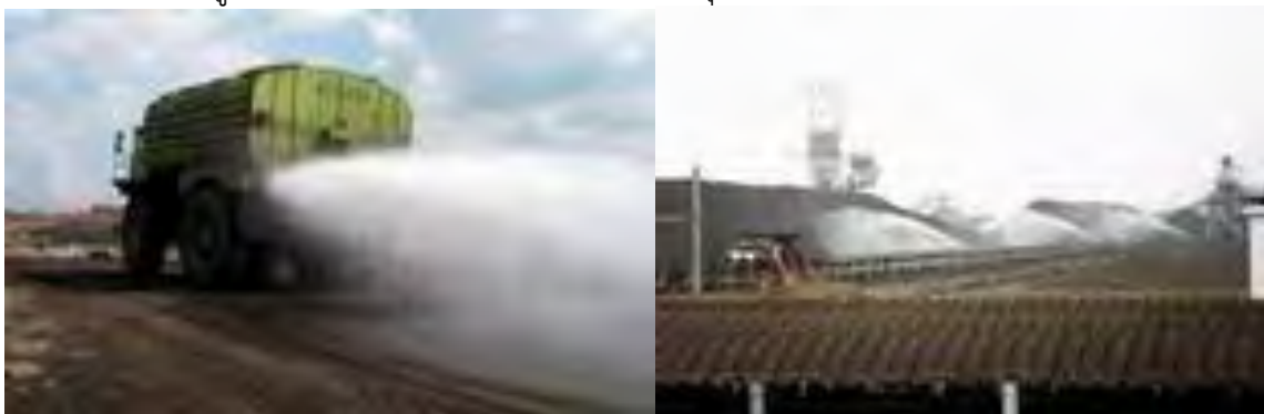
รูปที่ 2- 2 รถฉีดน้ำพรมถนนและลานกองถ่านหินช่วยลดฝุ่น
