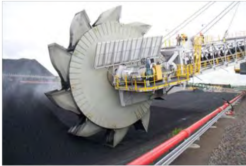
รูปที่ 2- 6 แสดงอุปกรณ์ที่ใช้ตักถ่านหินเพื่อลำเลียงสู่เตาเผา Reclaimer (ซ้าย) Stacker (ขวา)
