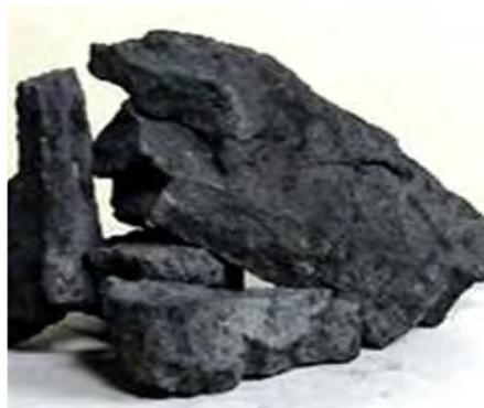
รูปที่ 2-8 ลักษณะของถ่าน Metallurgical coke [66]
