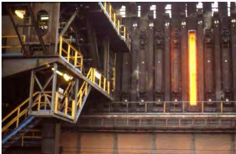
รูปที่ 2-9 ภาพ Coke ร้อนในเตาย่อยๆใน Coke oven [26]
