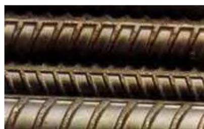
รูปที่ 2-12 เหล็กข้ออ้อย [85]
